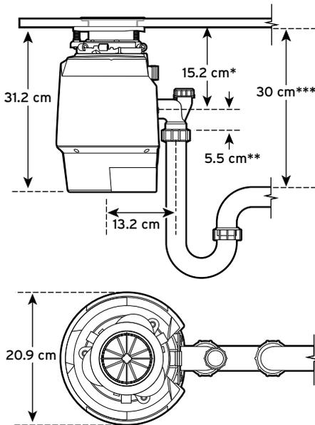
\* Distancia desde la parte inferior del fregadero hasta la línea central de la salida del triturador. Agregar 12,7 mm si utiliza fregaderos de acero inoxidable.
