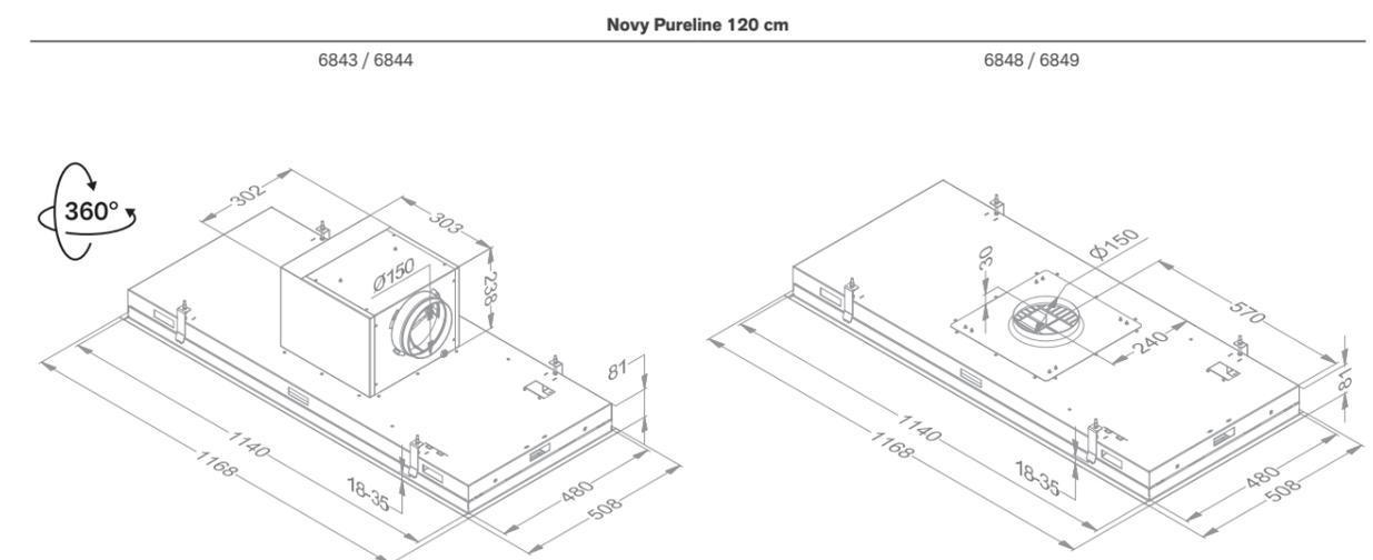
(1) Estos modelos deben ir conectados a motores intermedios, fachada o tejado, en accesorios ver pág. 220-221. El volumen de aire/nivel sonoro dependerá del tipo de motor e instalación.
