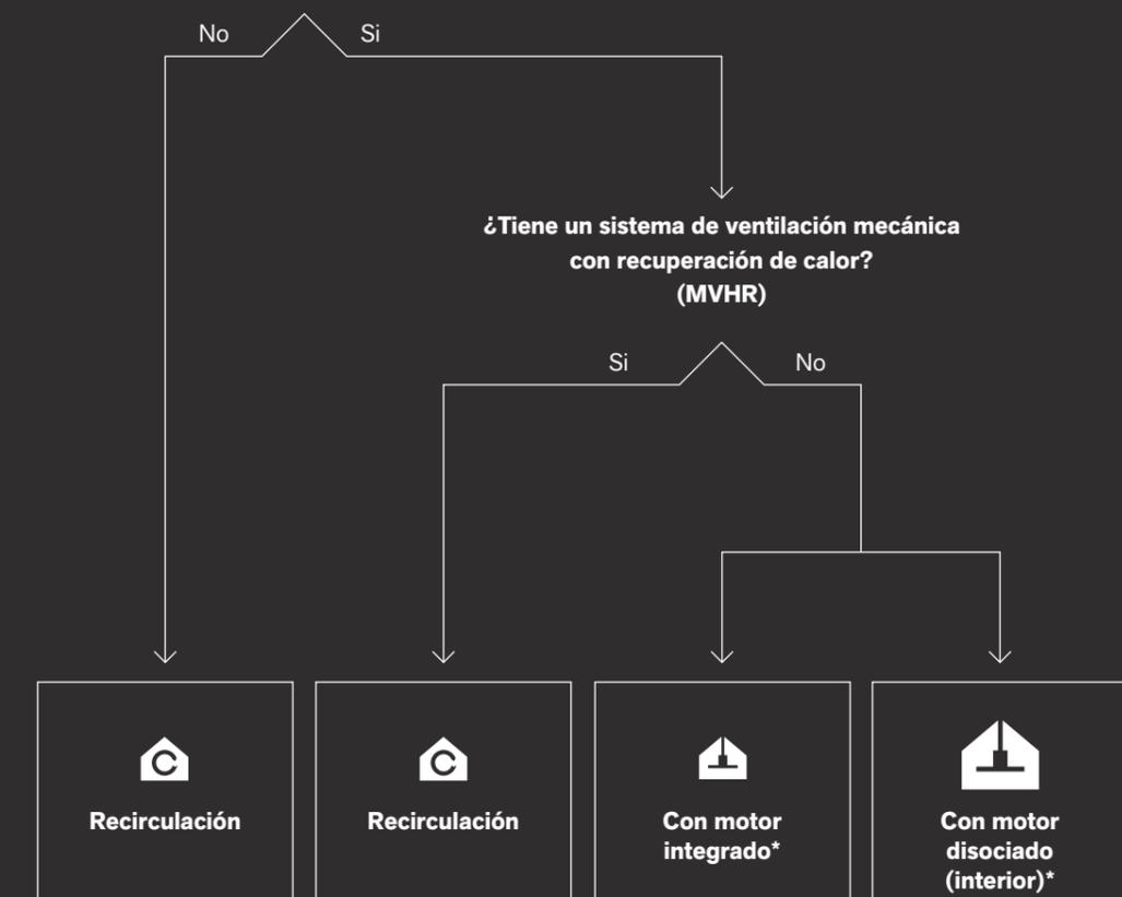
La extracción al exterior es la mejor solución, pero la recirculación es una óptima opción cuando no hay otra solución o la eficiencia energética manda. El espacio debe tener suficiente ventilación (a tener en cuenta por el instalador).
