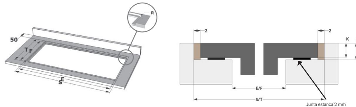
(2) Para garantizar una ventilación y disipación de calor óptimas del aparato, se debe proporcionar un espacio de circulación de aire entre la superficie de trabajo y el cajón.
