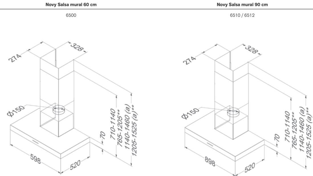
(a) Con extensión de chimenea - \*\* con recirculación.
