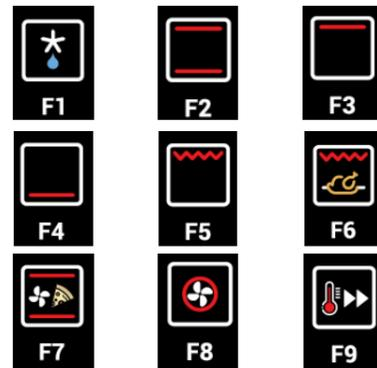
9 funciones: descongelación, estática, resistencia superior, resistencia inferior, rejilla de arena con asador, corrección de pizza, precalentamiento rápido
