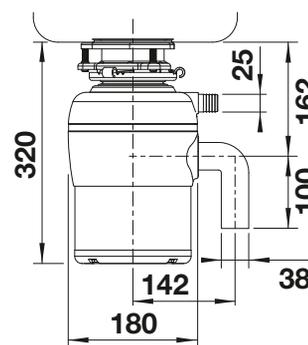
Se requiere una salida de fregadero de 3 1/2", Peso del producto: 7,4 kg, Cable de alimentación de 90 cm no extraíble, Botón de reinicio en la parte inferior (tenga en cuenta la accesibilidad)
