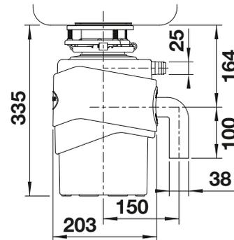
Se requiere una salida de fregadero de 3 1/2", Peso del producto: 10,6 kg, Cable de alimentación no extraíble de 90cm, Botón de reinicio en la parte inferior (tenga en cuenta la accesibilidad)
