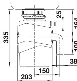
Se requiere una salida de fregadero de 3 1/2", Peso del producto: 10,2 kg, Cable de alimentación no extraíble de 90 cm, Botón de reinicio en la parte inferior (tenga en cuenta la accesibilidad)
