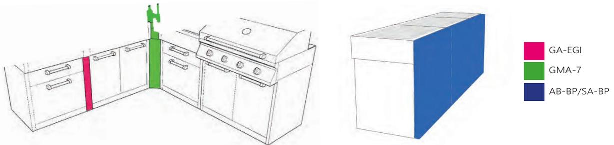
En las configuraciones que incluyen el módulo para el Big Green Egg, referencia G7C-BGE, se requiere un espaciador GA-D/AB-D de 100 mm para cada módulo de la configuración.
