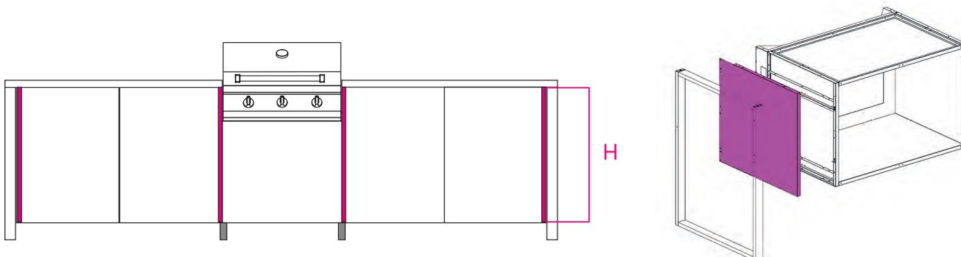
5.2. En caso de instalación en isla, los PANELES TRASEROS deben incluirse en una cantidad igual al número de módulos; la altura de los paneles debe coincidir siempre con la altura del módulo de referencia, excepto en el caso de los módulos que albergan encimeras de barbacoa. En este caso, la altura del panel debe ser igual a la altura del mueble base más 200 mm, necesarios para cubrir también la parte trasera de la barbacoa.
