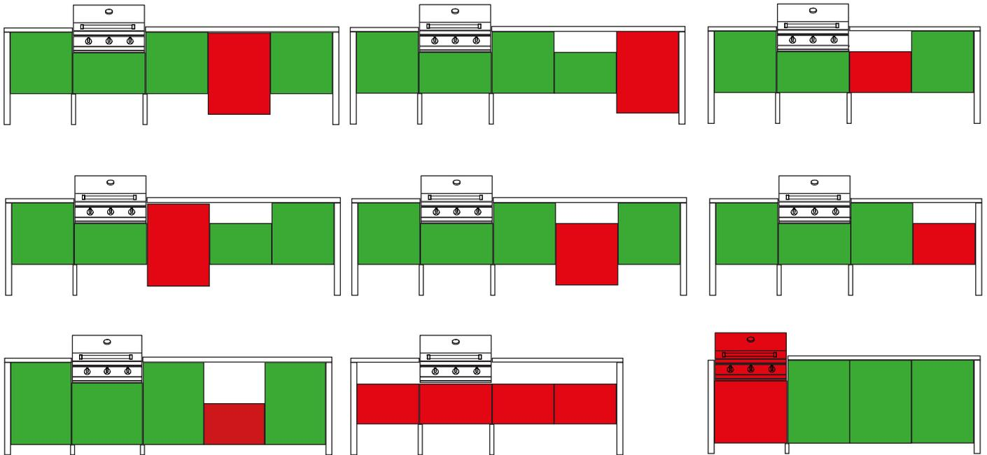
2.2. Las configuraciones pueden tener módulos de diferentes alturas. En este caso, debe mantenerse la alineación superior, y siempre debe colocarse una pata de apoyo TA-TT9 entre los módulos de diferentes alturas (véanse las figs. A y B).
