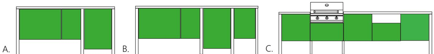
Para las cocinas GEA en las que un módulo sólo está alineado en la base inferior (ver figura C.), se recomienda prever paneles laterales de relleno a la altura de los módulos adyacentes y paneles superiores de relleno para los módulos no alineados con la encimera a la anchura del módulo más bajo.
