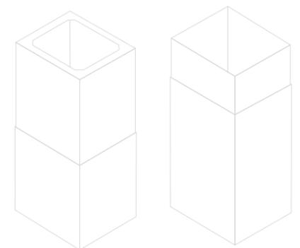
Zona telescópica de 150 mm. Especifique la altura total de la campana en el momento del pedido. A partir de 1200 mm se incluye una brida externa de sujeción y el embellecedor de la misma.
