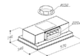
Kit de recirculación compatible con cualquier marca y tipología de sistema de extracción. Conexión desde el sistema de extracción con tubo rectangular de 222x90mm o 220x90mm. Conexión desde la parte superior con tubo redondo de Ø150mm. Incorpora dos filtros High Performance regenerables con el 98% de eficiencia en la retención de grasas. Fijación al forjado o bien a falso techo.
