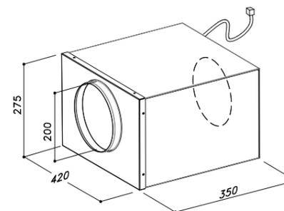
**TZ PVC150: Conducto de salida de aire**
